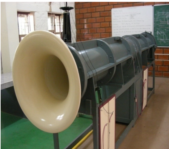
Fig. 2 Ducted Axial Fan Rig
