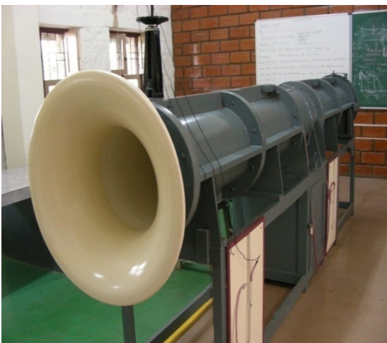
Fig. 2 Ducted Axial Fan Rig
